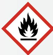
**DANGER** - Contient Acétate de n-butyle; Acétate d'éthyle; Hydrocarbures, C6, isoalcanes, <5% n-hexane; Acides gras insaturés en C14-18 et C16-18, maléates; anhydride maléique. H222 : Aérosol extrêmement inflammable. H229 : Récipient sous pression: peut éclater sous l'effet de la chaleur. H315 : Pro-
