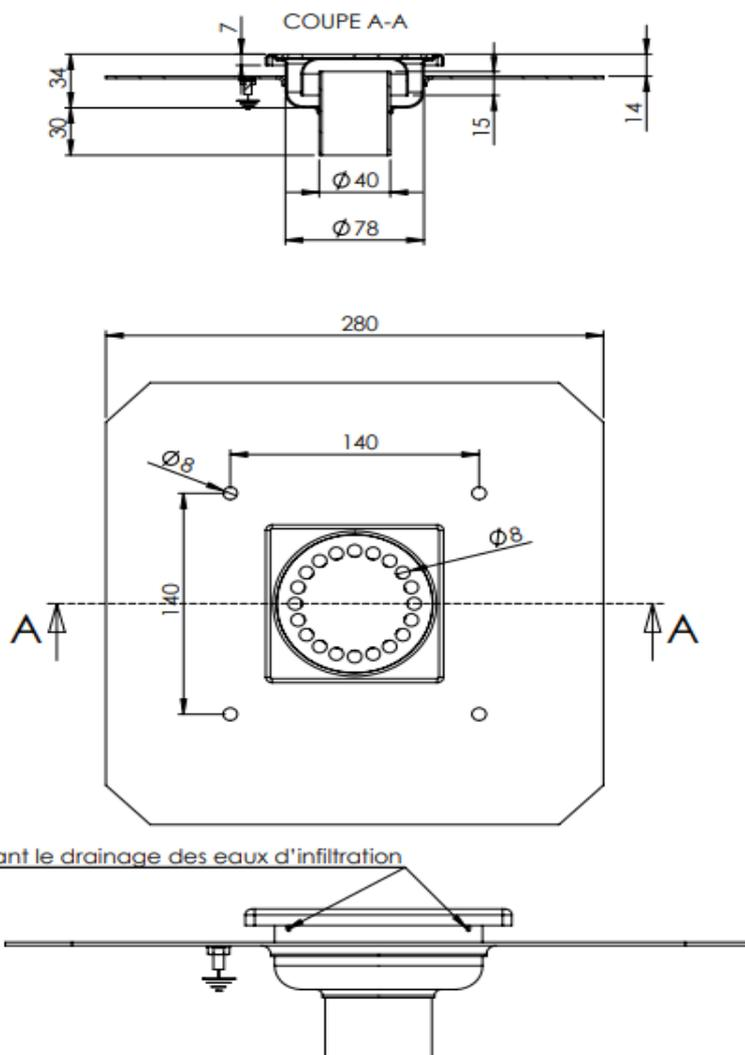
3 trous permettant le drainage des eaux d'infiltration
